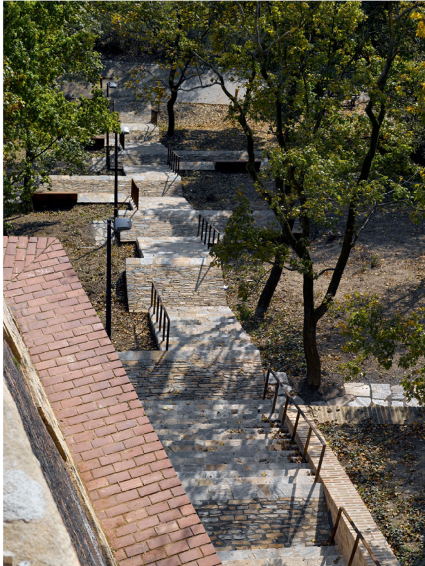
"stupně na terénu" - krátká zkratka svahem s několika lavičkami a s výhledem do údolí Svitavy; stupně vytvářejí pobytové / odpočinkové místo uprostřed svahu; šířka stupňů 2 m, postranní vyhlídkové podesty s dřevěnými lavičkami
